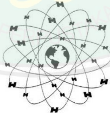
Gambar 2.9 Ilustrasi konfigurasi orbit satelit-satelit GPS (Sumber: fas.org)
