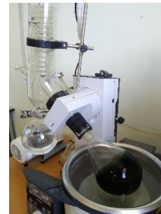
Pemekatan ekstrak dengan instrumen Rotary Evaporator
