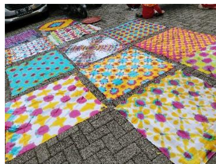
Proses pengeringan kain setelah diolesi waterglass
