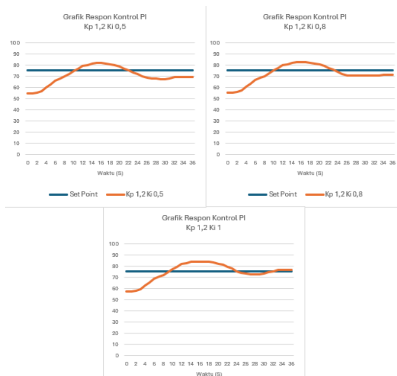
Gambar 4. 5 Grafik respon proportional dan integral pada parameter kelembaban
