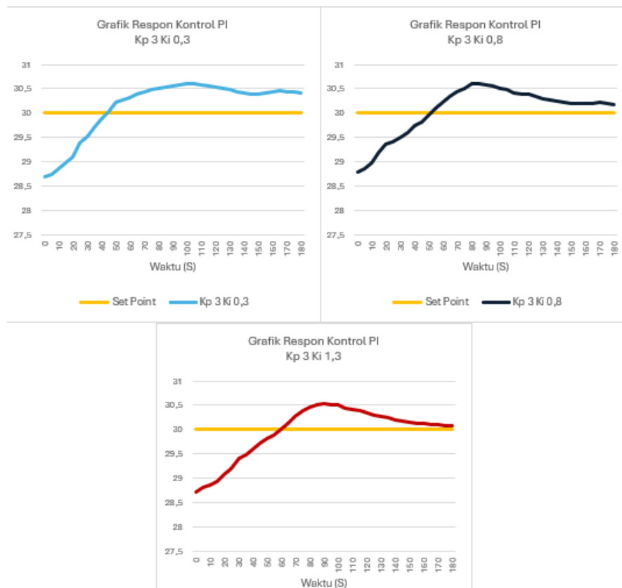
Gambar 4. 4 Grafik respon proportional dan integral pada parameter suhu
