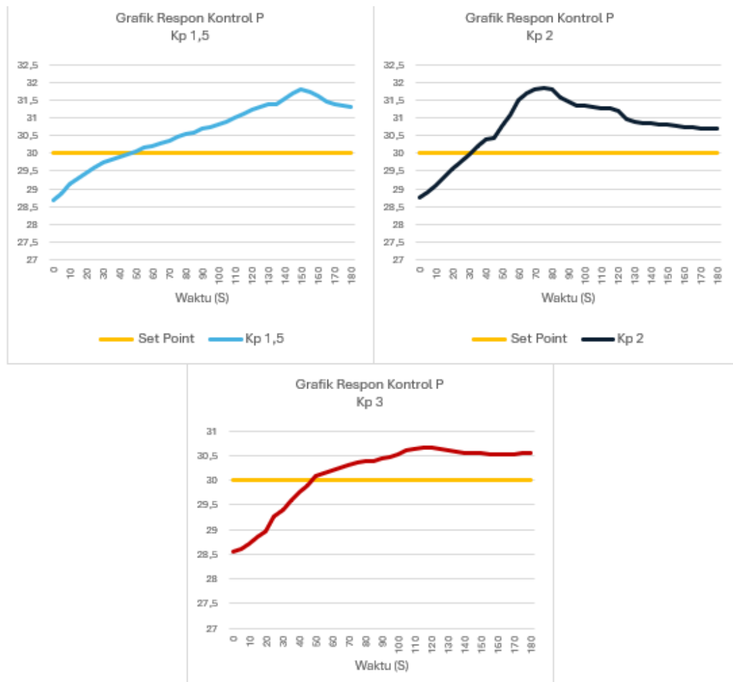
Gambar 4. 2 Grafik respon proportional pada parameter suhu
