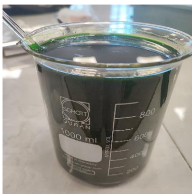
Pelarutan serbuk simplisia dengan etanol 96% (perbandingan 1:10)
