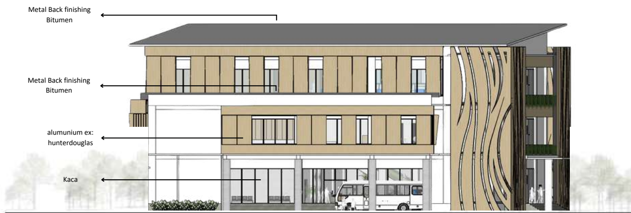
TAMPAK SAMPING KANAN BANGUNAN UTAMA 1:400
