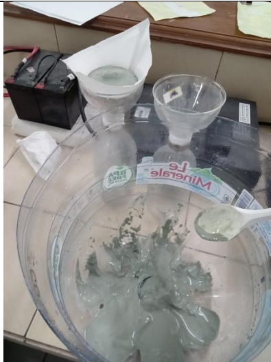
Proses pencucian zeolit setelah proses perendaman menggunakan larutan HF 1%
