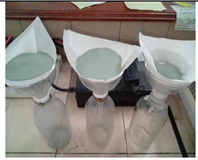
Proses penyaringan setelah perendaman menggunakan aquades
