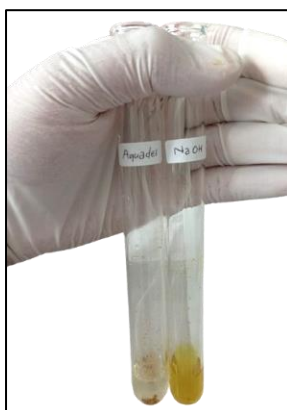
Gambar 4.3 Hasil uji kelarutan ligan basa Schiff dalam akuades dan NaOH 2M
