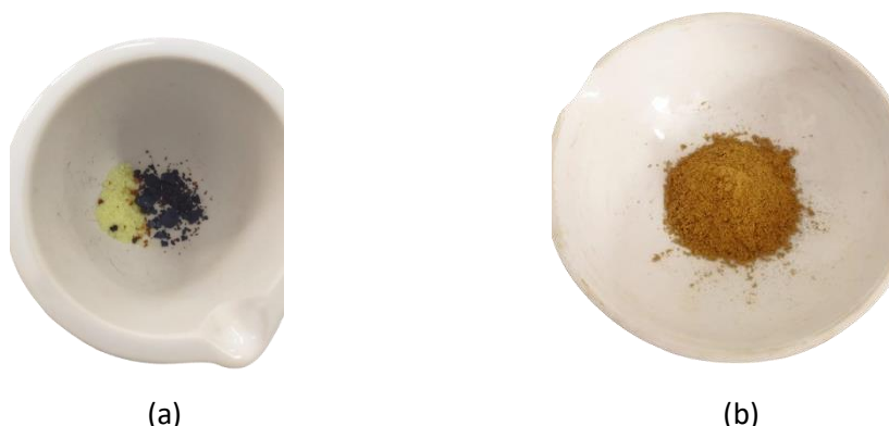
Gambar 4.2 (a) Reaktan o -vanilin dan p -anisidina, dan (b) Hasil produk sintesis menggunakan metode penggerusan
