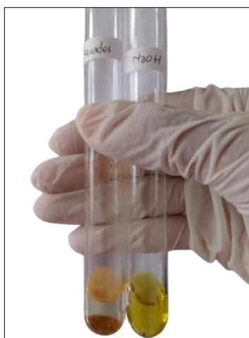
Gambar 4.4 Uji sifat kimia produk ligan 2-metoksi-6-(((4-metoksifenil)imino)metil)fenol dengan NaOH 2M
