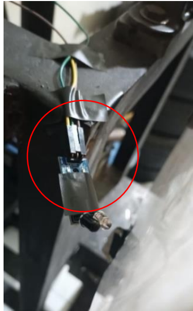
Gambar 4.3 Hasil pemasangan sensor infrared
