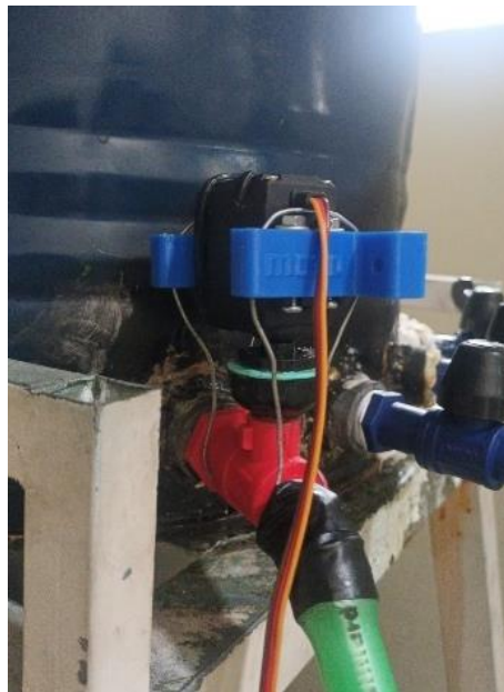
Gambar 4.22 Hasil pemasangan servo pada keran
