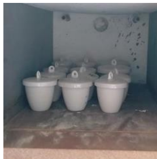
Kalsinasi menggunakan tanur pada suhu 750^\circ\text{C}
