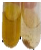
Gambar 4.4 Hasil uji kelarutan produk sintesis menggunakan NaOH 2 M (kiri) dan akuades (kanan)
