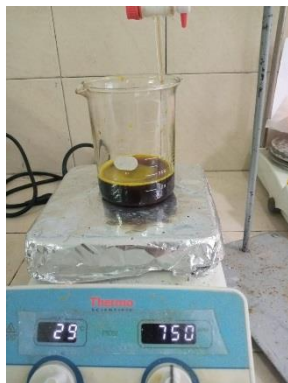
Proses pencampuran larutan \text{FeCl}_3 dengan ekstrak menggunakan buret
