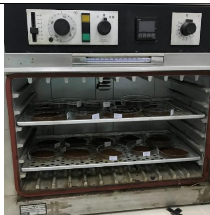
Uji kadar air menggunakan oven
