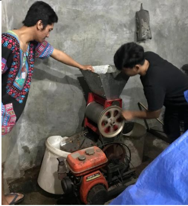
Pemisahan kulit buah kopi menggunakan mesin pulper
