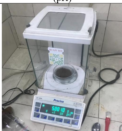
Penimbangan sampel setelah di oven untuk uji kadar air
