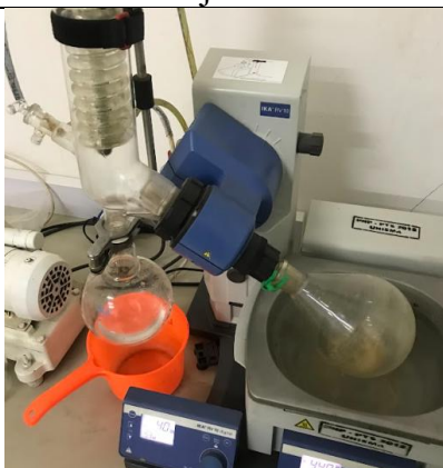
Ekstrak kopi diuapkan menggunakan rotary evaporator
