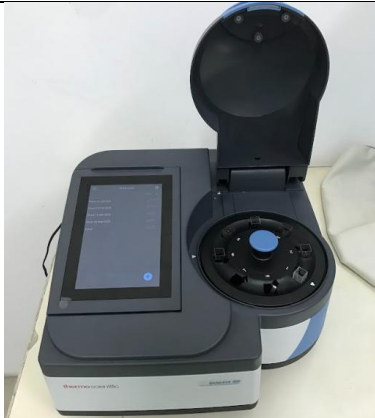
Pengukuran panjang gelombang menggunakan spektrofotometer UV- Vis
