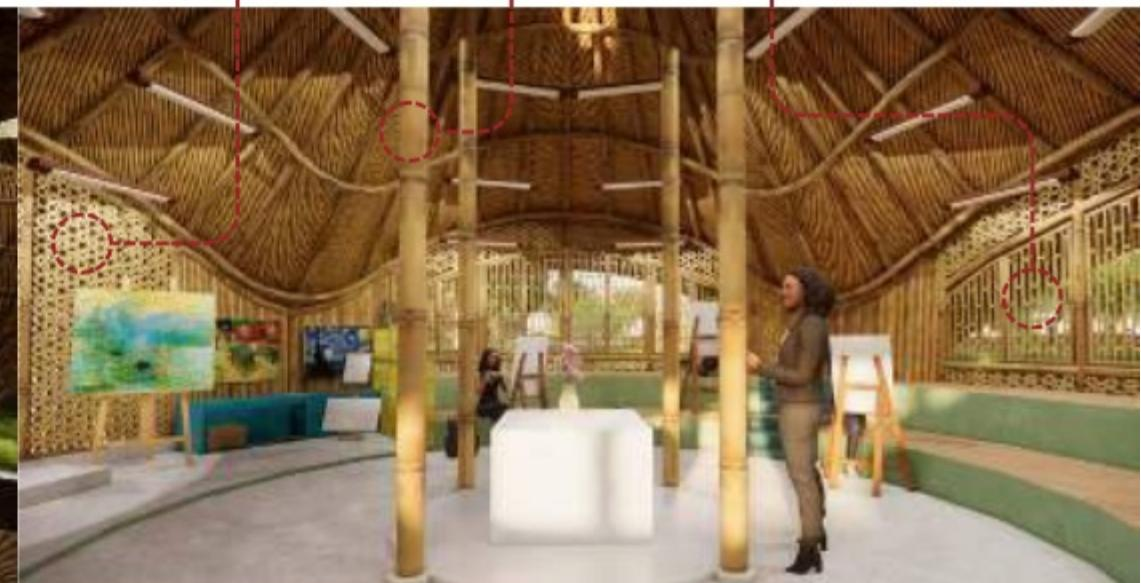
Penciptaan sirkulasi udara di **ruang lukis** dapat dilakukan dengan memanfaatkan dinding roster dan jendela bambu, yang akan mengoptimalkan aliran angin ke dalam bangunan. Selain itu, pencahayaan alami yang berasal dari void kaca di atas meja objek lukis berfungsi untuk membawa cahaya dari luar ke dalam ruangan.
