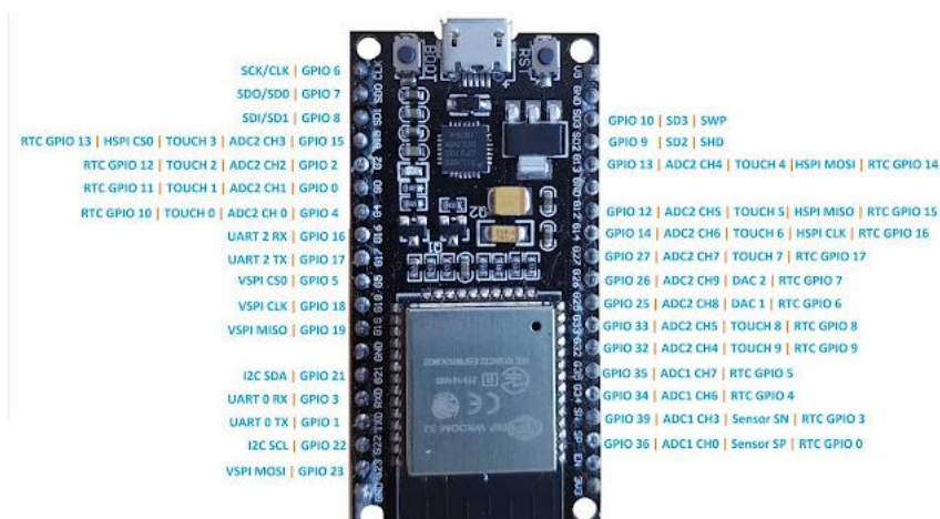
Gambar 2. 6 Pinout pada Mikrocontroller ESP32 (Yoga, 2020)
