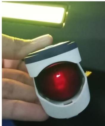
**Gambar 4. 1** Pengujian sensor MAX30102
