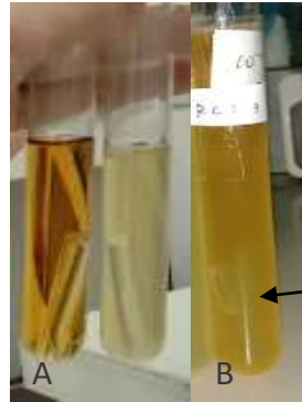
Gambar 4.2 Hasil uji penduga ayam goreng tepung (A) sampel blanko (B) hasil positif sampel ayam goreng tepung yang ditandai dengan adanya gelembung pada tabung durham dan terjadi kekeruhan pada media LB.
