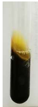
Gambar 4.8 Hasil uji biokimia bakteri Salmonella sp. (A) sampel blanko (B) hasil positif sampel ayam goreng tepung yang ditandai dengan endapan hitam dibagian bawah tabung reaksi pada media TSIA.
