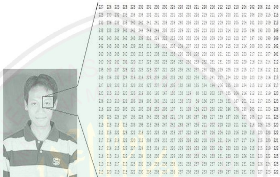
Gambar 2. 1 Citra Grayscale yang Diambil dalam Kotak Kecil pada Gambar itu Disimpan dalam Bentuk Angka-Angka dalam Memori Komputer
