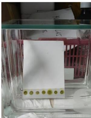
Gambar 4. 4 Proses elusi ekstrak kasar sampel pada plat KLT
