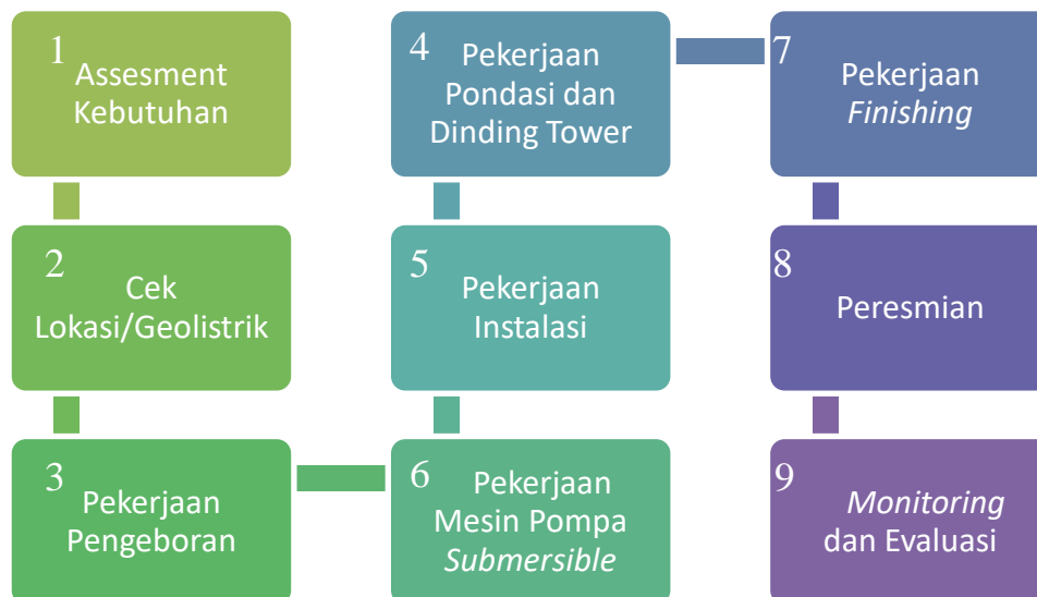
Gambar 4.6 Tahapan-Tahapan Pekerjaan Sumur Bor oleh BMH Sumber: BMH Kota Probolinggo (2023)
