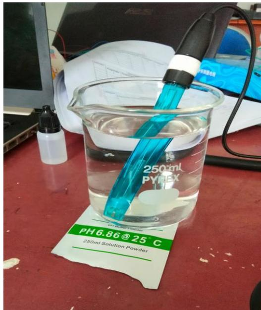
Gambar 4.7 Kalibrasi Sensor pH
