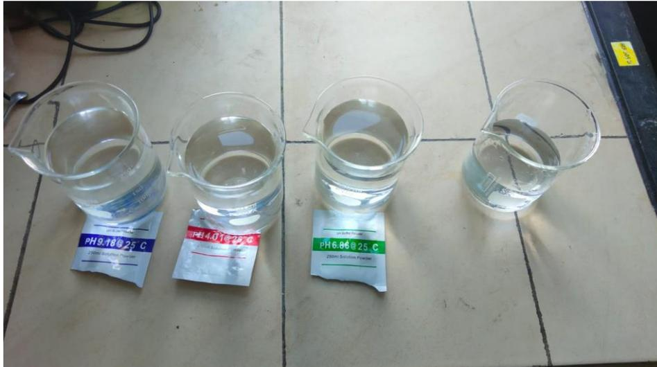
Gambar 4.6 Kalibrasi sensor pH dengan serbuk pH
