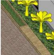
Batu alam yang digunakan di sepanjang jalur pejalan kaki berfungsi sebagai pengkerasan pada taman, memastikan bahwa area tersebut tetap stabil dan aman untuk dilewati.
