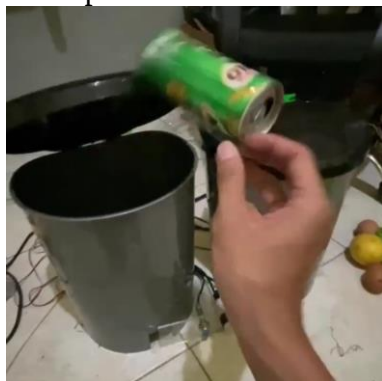
Respond tempat sampah saat mendeteksi bahan logam
