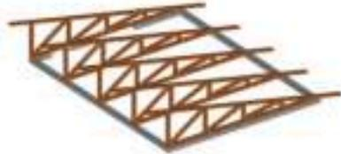
Menggunakan rangka kuda-kuda kayu agar penghawaan dan pencahayaan dapat masuk ke dalam bangunan secara alami.
