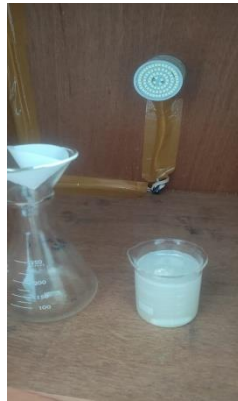
Gambar L.9.5 Proses penyaringan larutan hasil fotodegradasi
