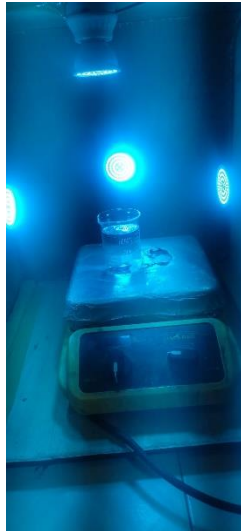
Gambar L.9.4 Uji aktivitas fotokatalitik di dalam fotoreaktor dengan lampu UV
