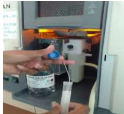
Proses analisis logam berat air laut dengan AAS
