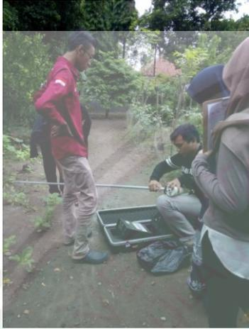
**Gambar 1. Pemasangan alat Magnetometer**
