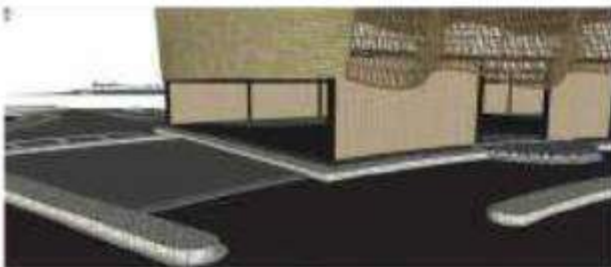
Akses untuk barang dibuatkan loading dock untuk masuk dan keluar material dan produk
