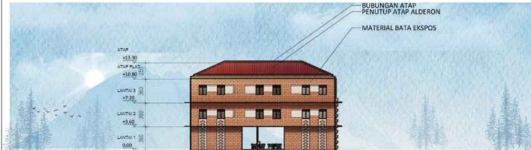
TAMPAK SAMPING KANAN GEDUNG MTS 1 : 250
