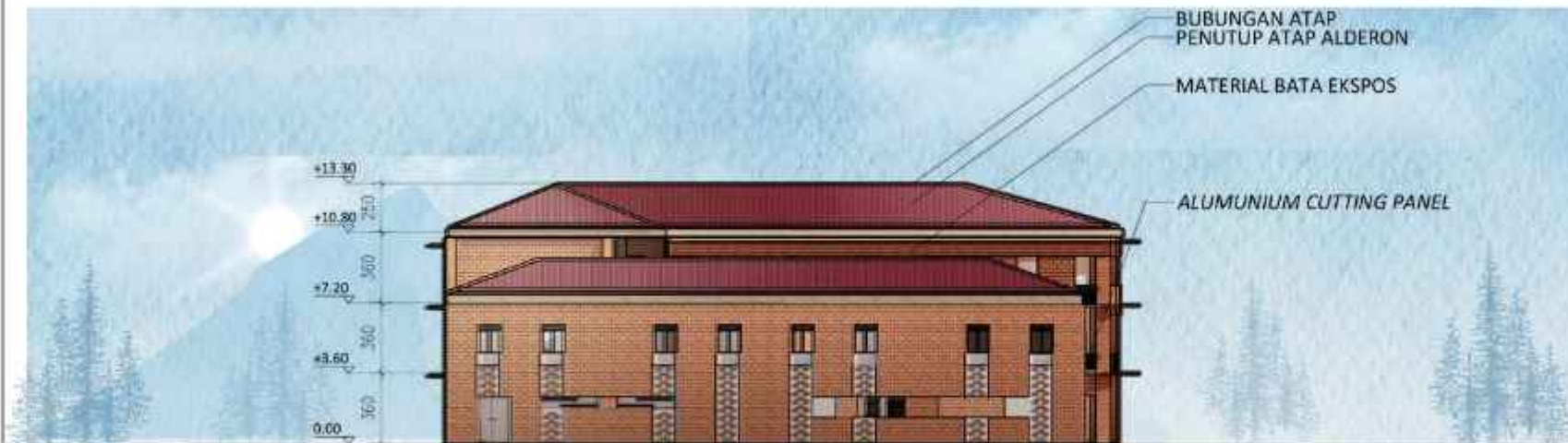
TAMPAK SAMPING KANAN GEDUNG MA 1 : 250
