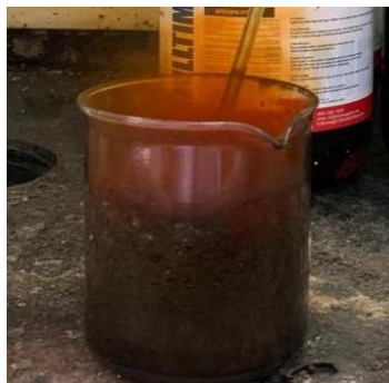
Destruksi limbah besi dengan HNO 3
