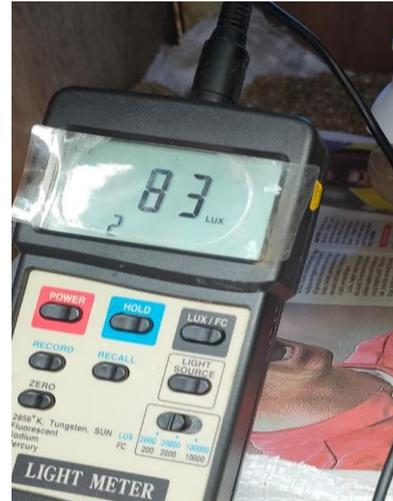
**Perhitungan Intensitas dengan flux meter**
