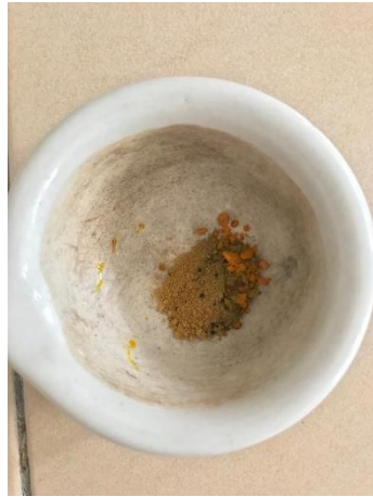
Pencampuran ligan basa 2-metoksi-6(((4-metoksifenil)imino)metil)fenol dengan \text{FeCl}_3 \cdot 6\text{H}_2\text{O}
