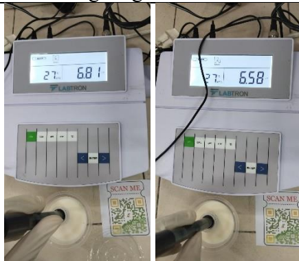
Hari-0 Pengujian pH menggunakan alat pH meter
