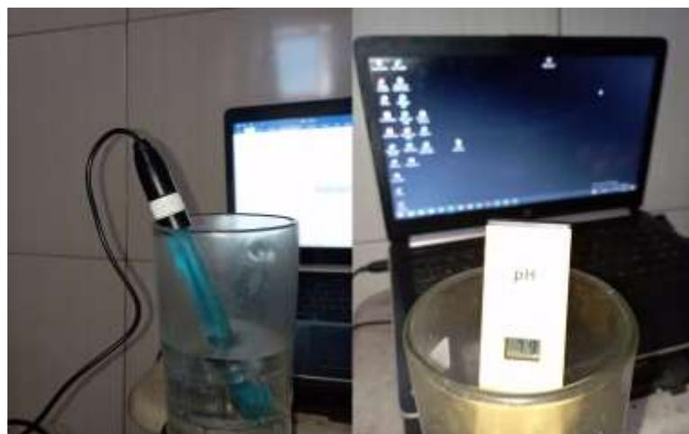
**Gambar 4.4** (A) Pengukuran PH Menggunakan PH Meter (B) Pengukuran PH Menggunakan Sensor PH Air berbasis WSN LoRa
