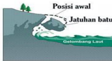
Gambar 2. 4 Runtuhan Batuan (PVMBG, 2015)
