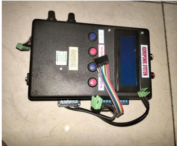
Gambar 4.6 Perakitan Mikrokontroler Arduino dan sensor Suhu/Kelembapan
