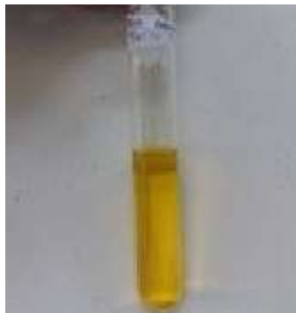
Gambar 2. 6 Larutan kuning hasil penambahan DNS kedalam campuran pati dan enzim amilase (Miksusanti dkk., 2019)
