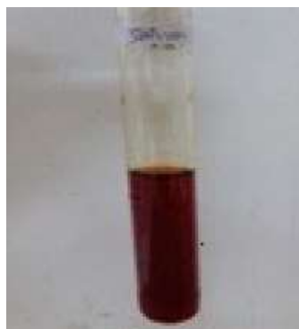
Gambar 2. 7 Larutan merah bata hasil pemanasan campuran DNS, pati, dan enzim amilase (Miksusanti dkk., 2019)
