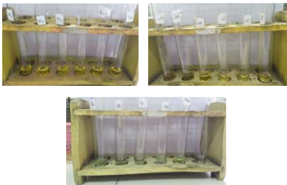
Gambar 4.3 Hasil analisis kualitatif pengujian kadar logam berat Hg dan Pb pada sampel lotion
