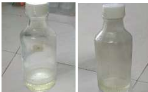
Gambar 4.1 Hasil destruksi sampel lotion sebelum ditambahkan \text{H}_2\text{O}_2 (kiri) dan setelah ditambahkan \text{H}_2\text{O}_2 (kanan)
