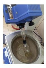
Penguapan dengan rotary evaporator
