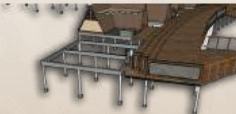
rangka unit glamping ini terdiri dari baja IWF sebagai balok, kemudian beton precast membentuk plat lantai
