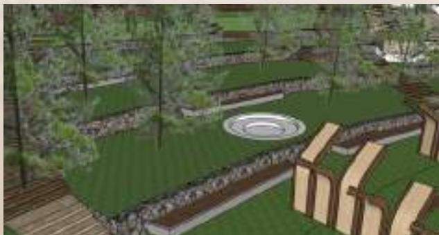
struktur penahan tanah pada area taman hutan menggunakan gravity wall, gravity wall digunakan dengan ketiga kontur 1-2 meter, struktur ini menggunakan beratnya sendiri untuk menahan tanah
