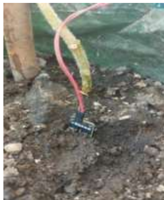
Gambar 4. 5 Pemasangan sensor kelembaban tanah pada tanaman tomat
