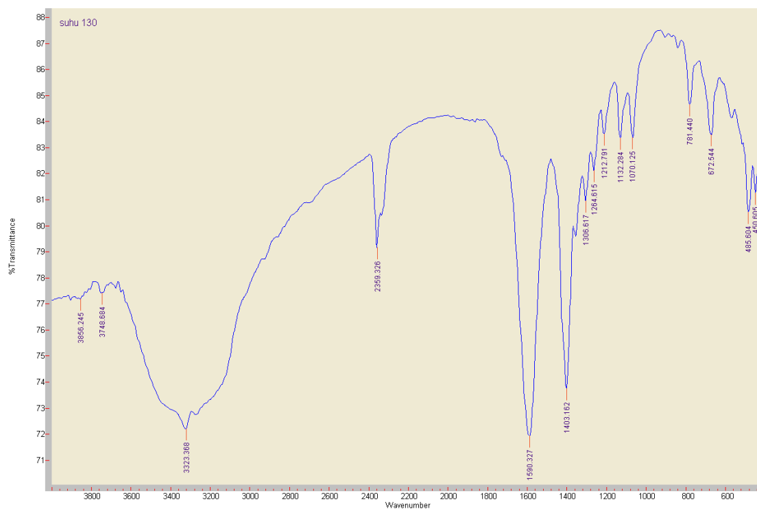
Gambar L 4.4 FTIR hasil sintesis 4 senyawa kompleks serium(III)-tartrat pada suhu 130°C
