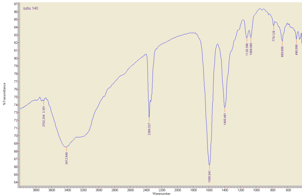
Gambar L 4.5 FTIR hasil sintesis 1 senyawa kompleks serium(III)-tartrat pada suhu 140°C
