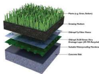
STRUKTUR LAPISAN GREEN ROOFTOP
