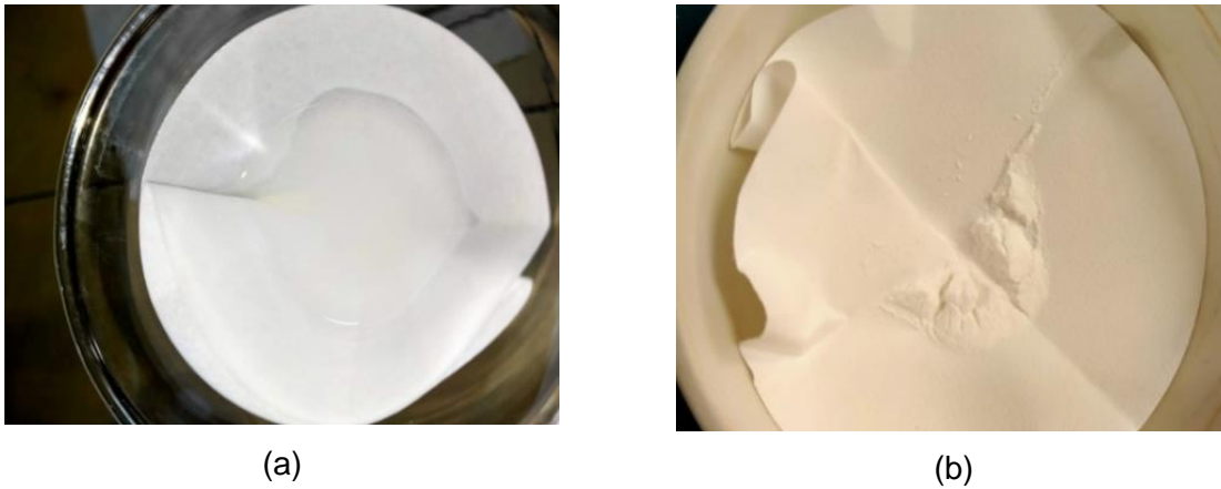
Gambar 4.1 (a) Produk setelah proses solvotermal; (b) Produk setelah pengeringan.
