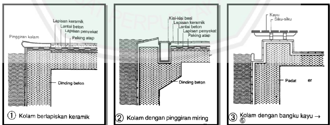
Gambar 2.39 Jenis dan komponen kolam renang (Sumber: Neufert, 1996: 227)
