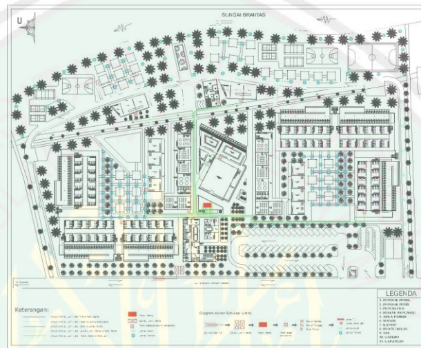
Gambar 6.43 : Utilitas air bersih dan air kotor
