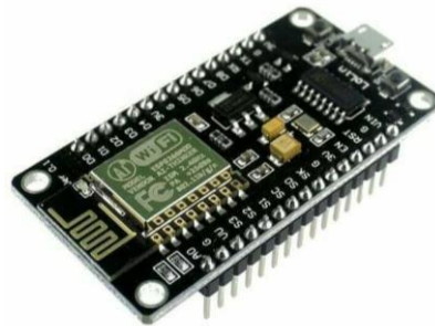
Gambar 2.6 Modul Wifi NodeMCU V3
