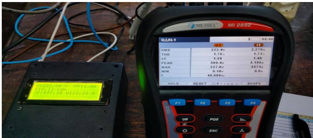
Gambar 4.6 Perbandingan nilai pada sensor dengan nilai pada PM
