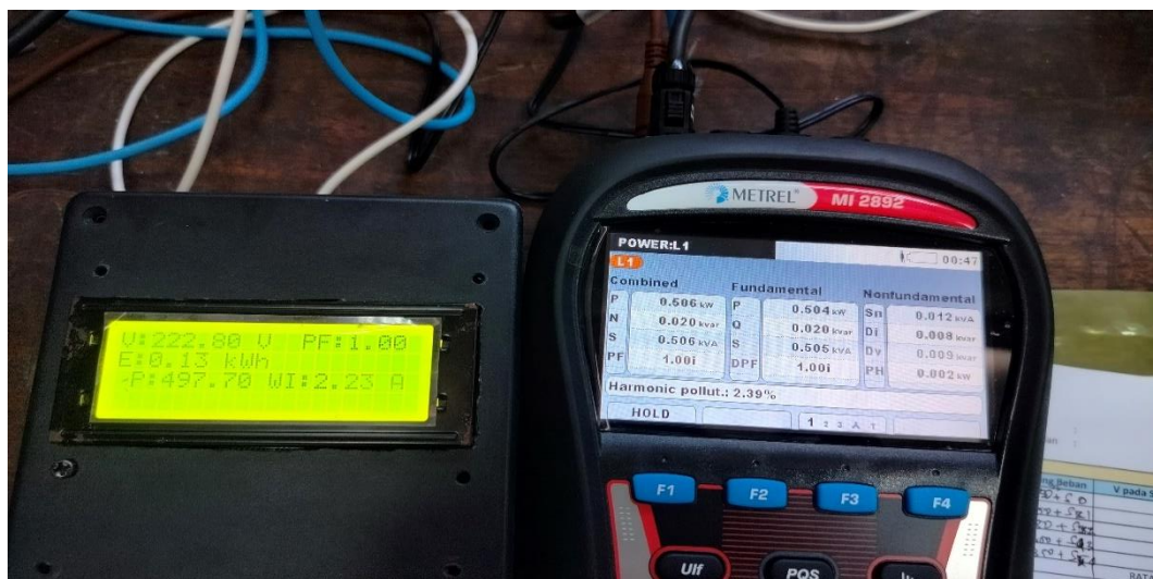
Gambar 4.7 Perbandingan nilai pada sensor dengan nilai pada PM
