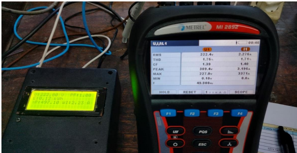
Gambar 4.5 Perbandingan nilai pada sensor dengan nilai pada PM
