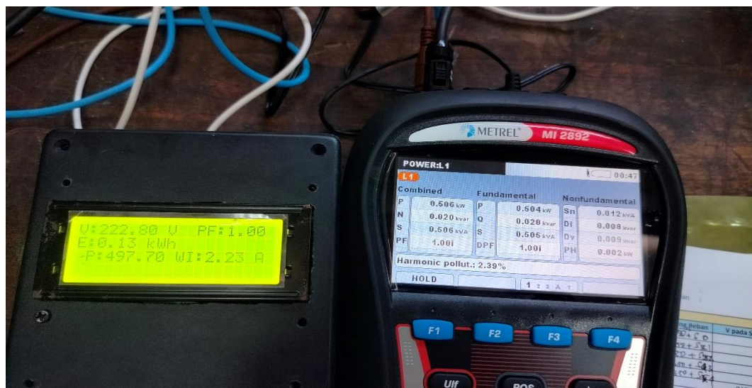
Gambar 4.8 Perbandingan nilai pada sensor dengan nilai pada PM
