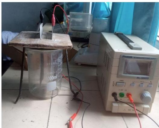
**Gambar 4.3** Rangkaian Reaktor Elektrokoagulasi
