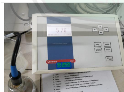
Pengukuran pH menggunakan pH meter
